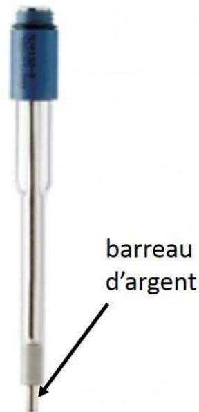
*Remarque* : une telle électrode est qualifiée d'électrode **attaquable**. Le métal fait partie du couple. Si du courant traverse l'électrode, du métal peut être produit ou consommé.
