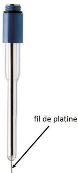
Remarque : une telle électrode est qualifiée d'électrode **inattaquable**. Le métal est noble, il n'est pas altéré lorsqu'on utilise l'électrode.
