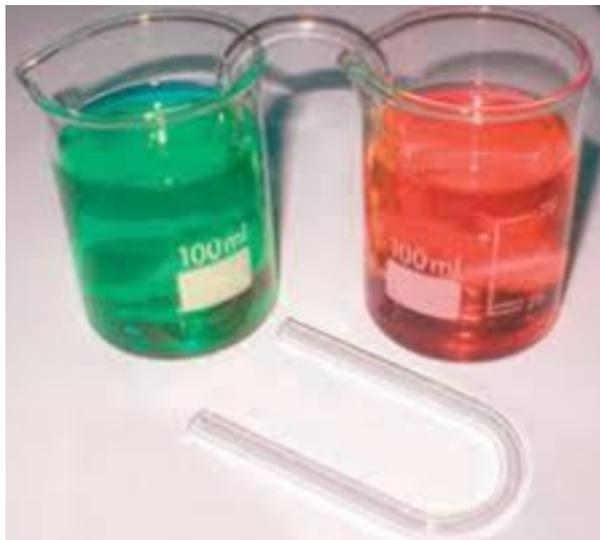
Un pont salin est constitué d'un gel imbibé d'une solution très conductrice : en générale, une solution saturée de  $\text{KCl}$ , de  $\text{KNO}_3$  ou de  $\text{NH}_4\text{NO}_3$ .
