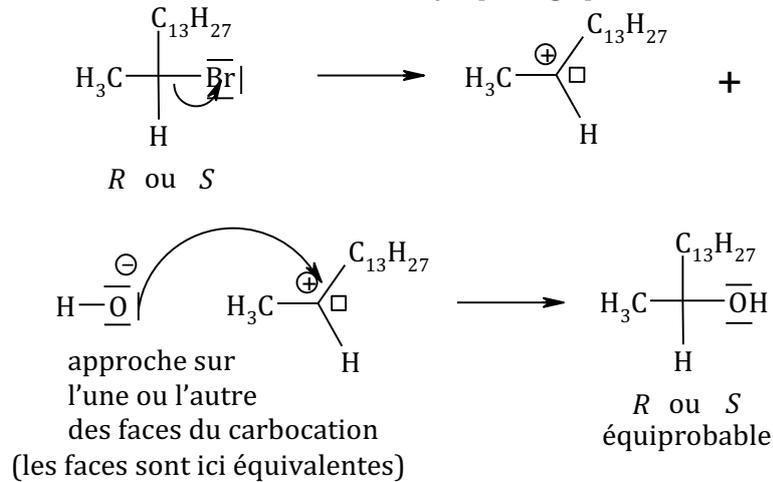
Si ce mécanisme était seul à se produire, on obtiendrait 50% d'alcool *R*, et 50% d'alcool *S* (indépendamment de la composition du mélange initial), ce qui n'est pas le cas.
