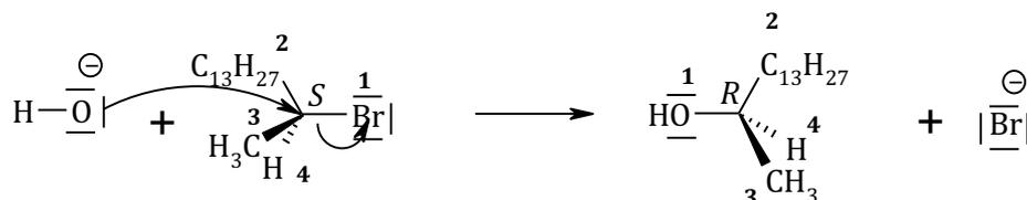
On vérifie que les ordres de priorité ne sont pas modifiés, il y a donc également une inversion de descripteur. Le mécanisme étant énantiospécifique, la réaction sur l'énantiomère  $R$  fournirait de
