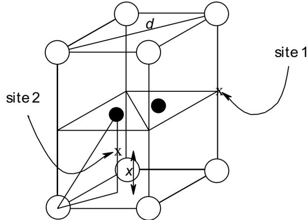
Site 1 : le centre de l'hexagone formé par six atomes de bore, c'est à dire le milieu de l'arête de longueur  $c$  de la maille. On peut insérer un atome de rayon  $R_{\text{B}} = 95,3 \text{ pm}$  au centre de l'hexagone, mais le long de l'arête, il n'y a de la place entre les deux zirconiums que pour un rayon  $r_1 = \frac{c}{2} - R_{\text{Zr}} = 12,5 \text{ pm}$ . Le site est donc de dimension  $r_1 = 12,5 \text{ pm}$ .
